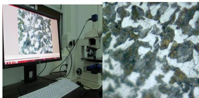
شكل (6) صورة مجهرية لعينة غير معالجة تظهر المنطقة البيضاء (الفيريت) و السوداء البيرليت أما عند التبريد السريع بواسطة الماء فكان الشكل الإبري الناتج يعبر عن المارتنزيت مع وجود جرافيت على شكل كروي شكل (7) إذا ما قورنت بالعينة التي قسييت بالزيت التي تحتوي على المارتنزيت و البايينيت مع وجود الجرافيت شكل (8) وهذا أيضاً يتفق مع مخطط TTT (ASM HAND book, 1991)
